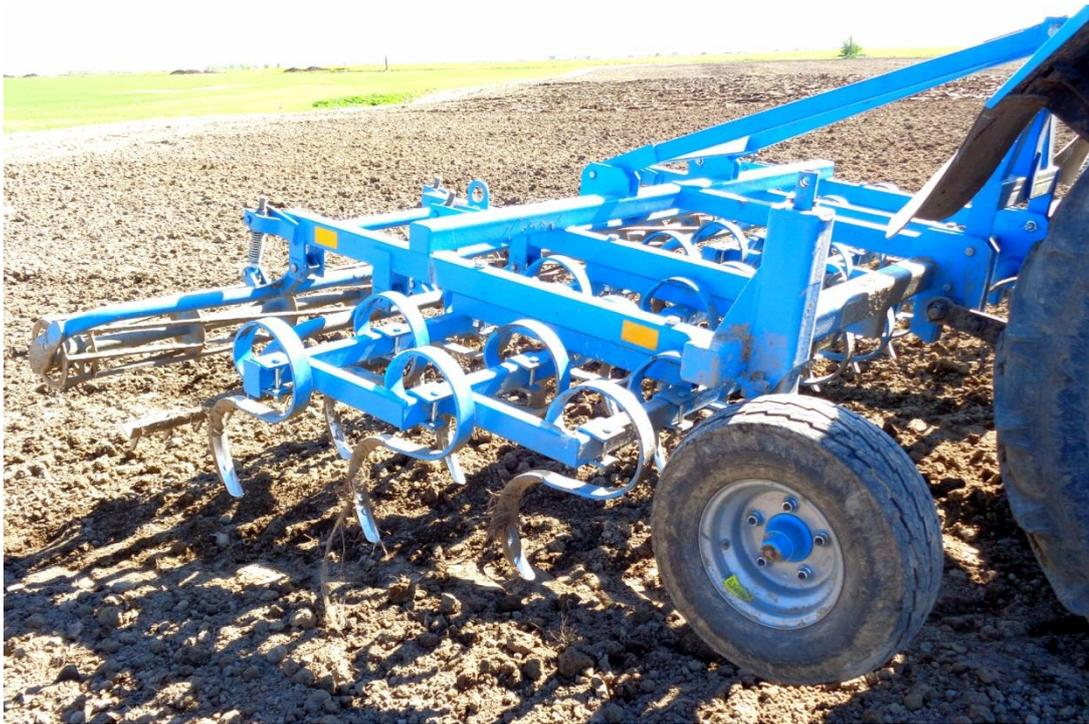
Культиватор блочно-модульный навесной КБМ-4,2НУ
