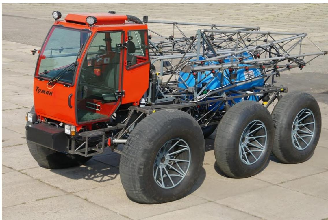
**Опрыскиватель-разбрасыватель самоходный «ТУМАН-1М» в комплекте
