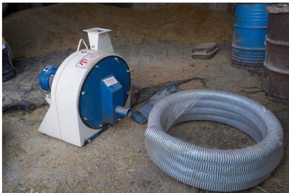
**ДРОБИЛКА ПНЕВМАТИЧЕСКАЯ МОЛОТКОВАЯ ДПМ-11**
