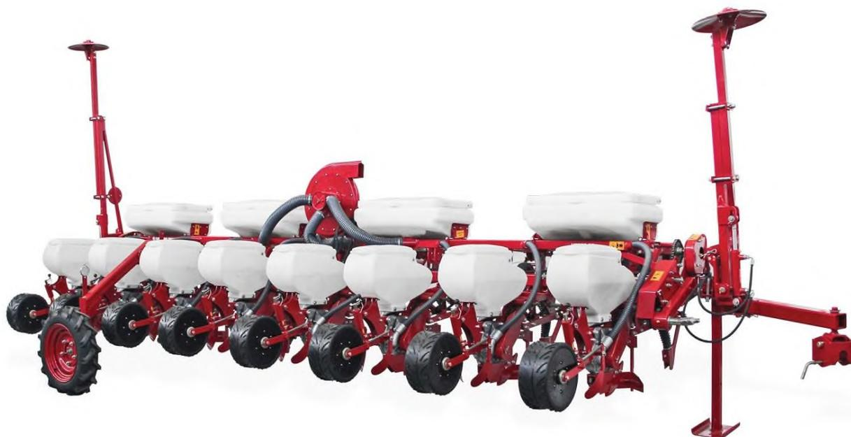
**Пневматическая сеялка точного высева УПС-8.**
