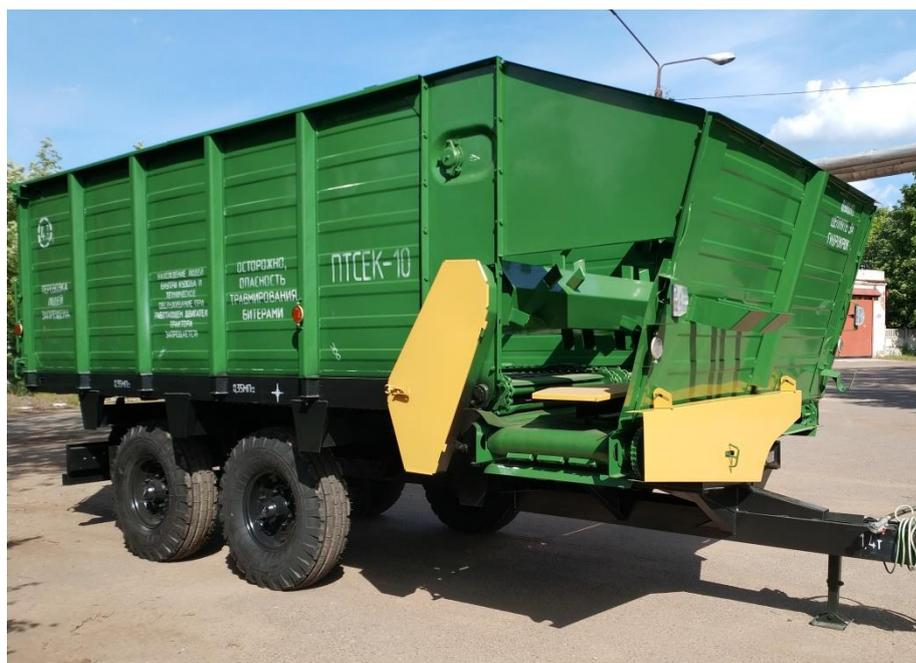
**Полуприцеп тракторный самосвальный ПТСЕК-10**
