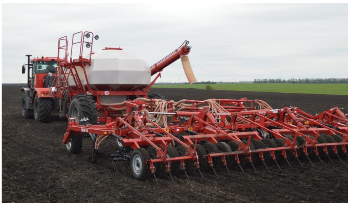
**Сеялка-культиватор пневматическая «Алькор-7,5»**
