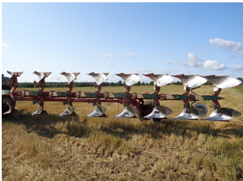
Плуг восьмикорпусный оборотный Kverneland PN 100
