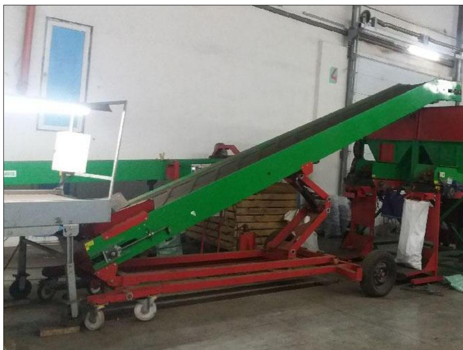
**КОНВЕЙЕР НАКЛОННЫЙ КН-650**
