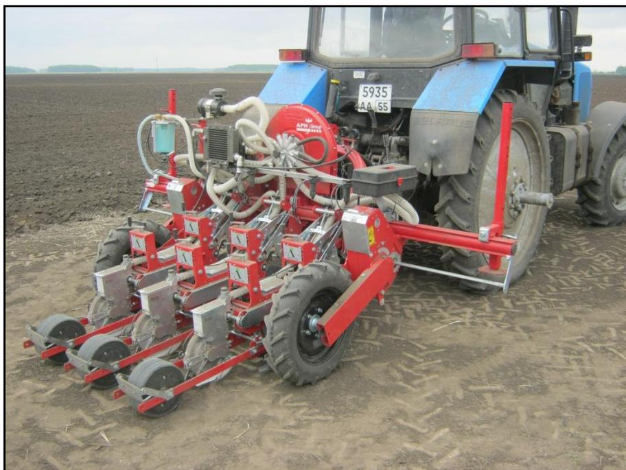
**Сеялка пневматическая точного высева SNT-2-290**
