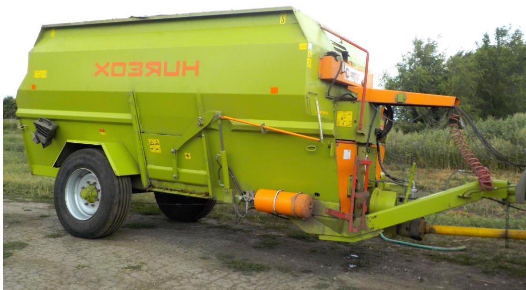
Измельчитель-смеситель раздатчик кормов ИСРК-12 «Хозяин»
