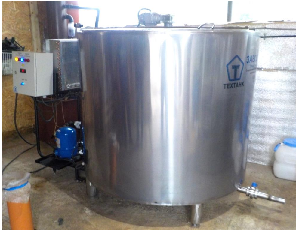
Танк-охладитель молока открытого типа НОМОЛ-2000
