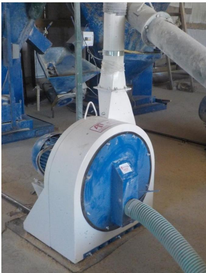
**ДРОБИЛКА ПНЕВМАТИЧЕСКАЯ МОЛОТКОВАЯ ДПМ-22**
