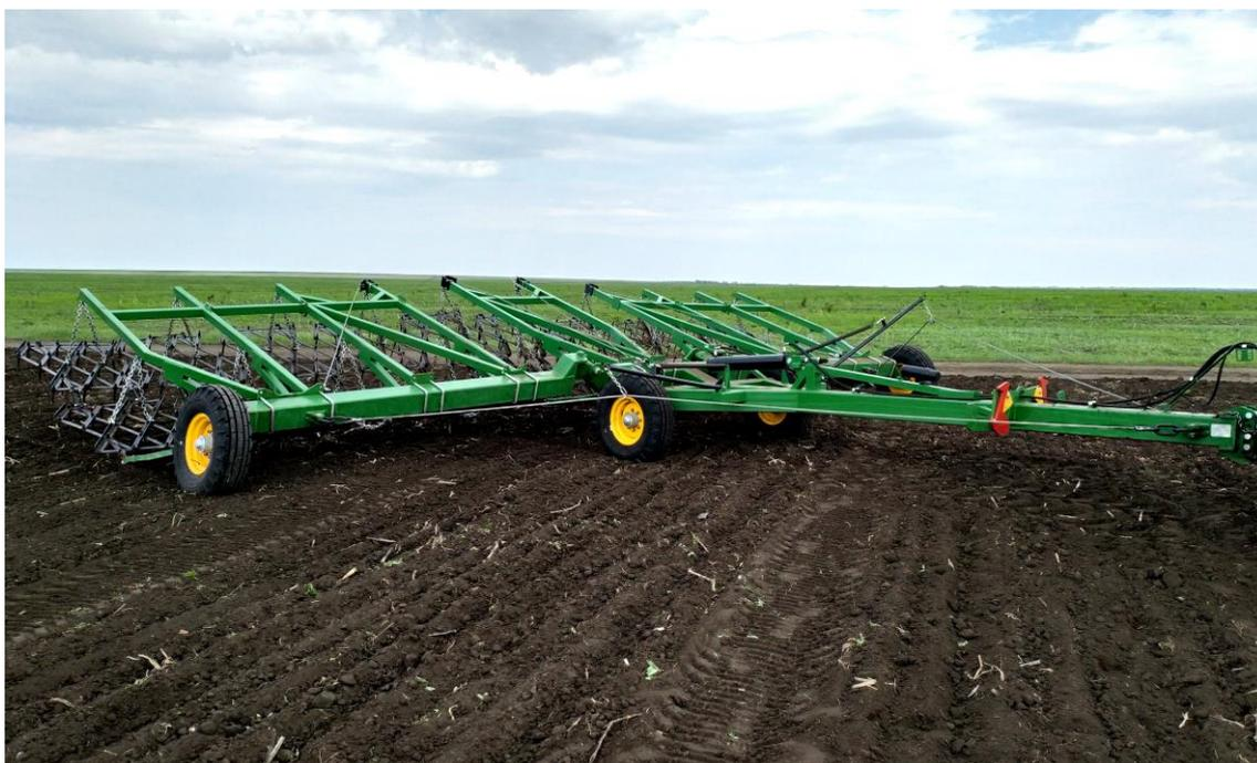
**Агрегата гидрофицированного складывающегося
