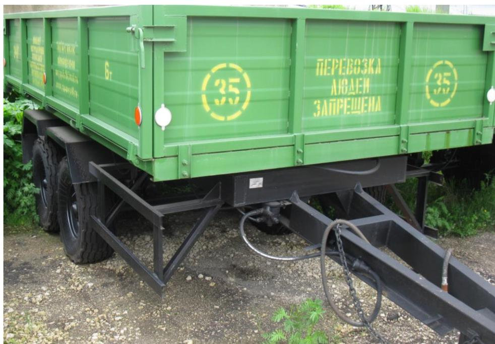
**Полуприцеп тракторный самосвальный ПШТС-6-01**
