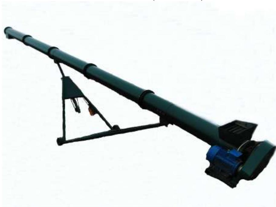
**Шнековый конвейер ШКС-10**
