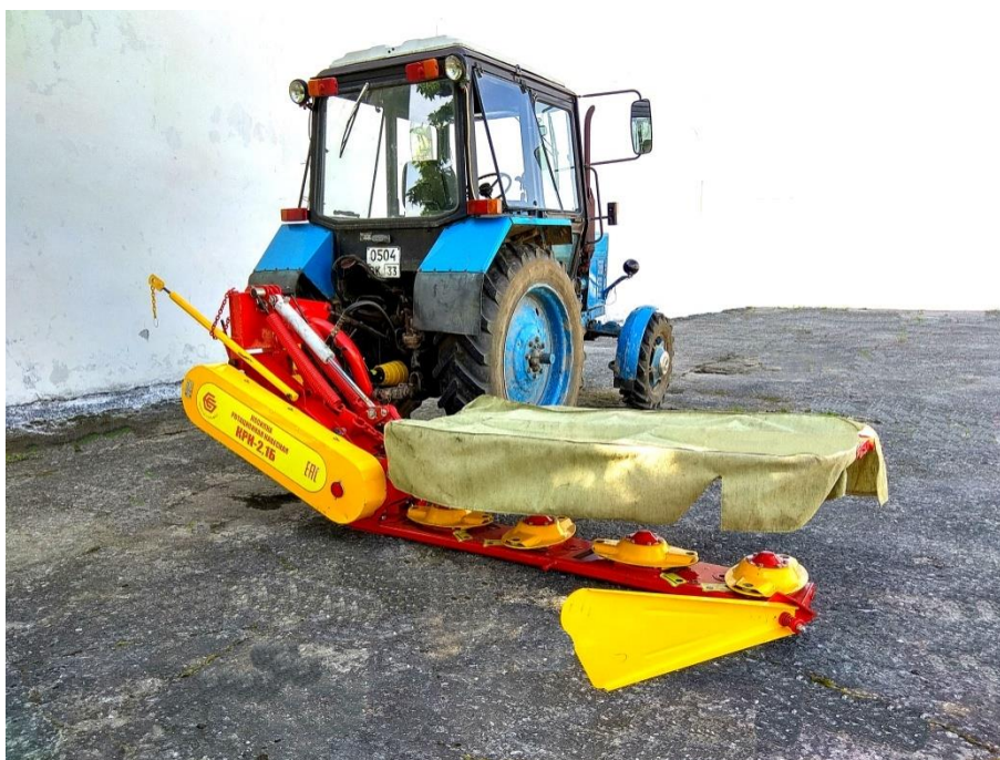
Косилка ротационная навесная КРН-2,1Б
