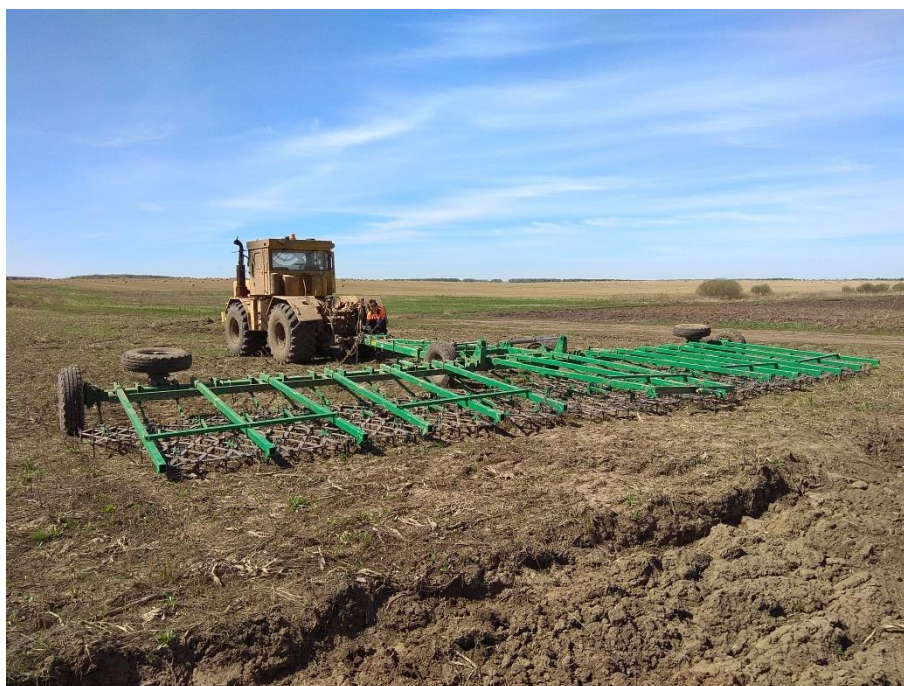
Сцепка гидрофицированная выравнивающая СГВ-15
