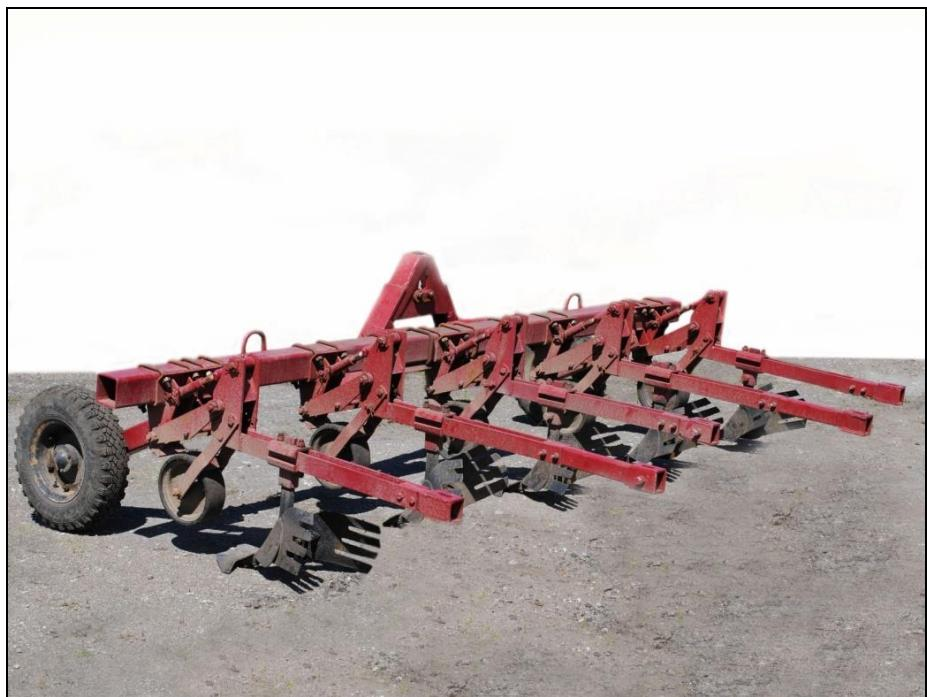
**КУЛЬТИВАТОРА ДЛЯ МЕЖДУРЯДНОЙ ОБРАБОТКИ ПОЧВЫ
