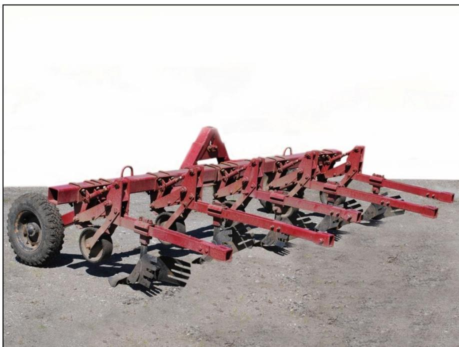
**КУЛЬТИВАТОРА ДЛЯ МЕЖДУРЯДНОЙ ОБРАБОТКИ ПОЧВЫ
