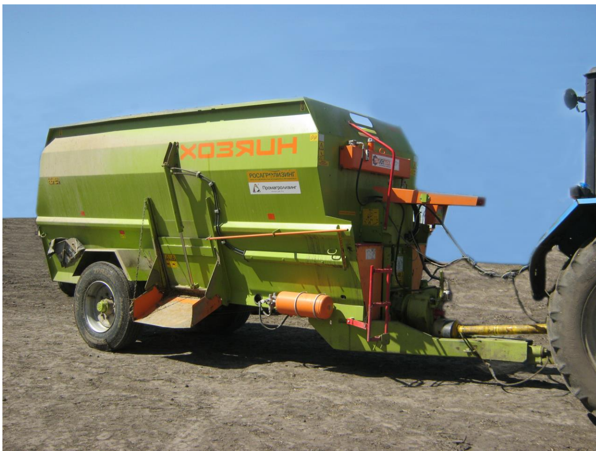
Измельчитель - смеситель раздатчик кормов ИСРК-15 «Хозяин»
