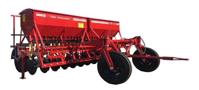
Сеялка зернотуковая прессовая СЗП-3,6Б
