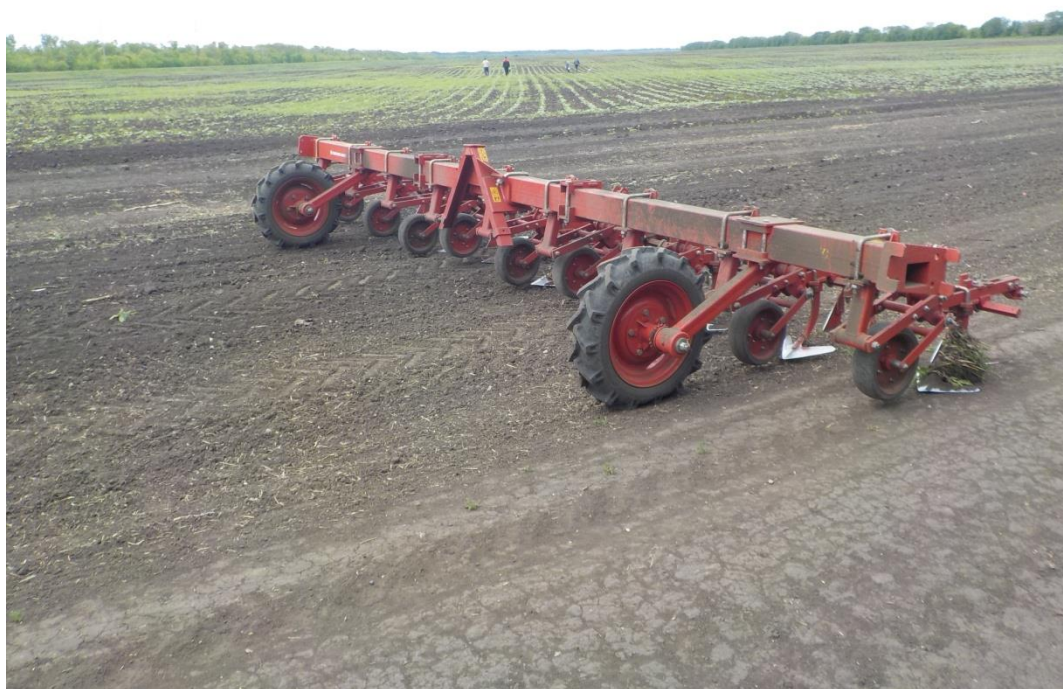
Культиватор навесной для высокостебельных культур КРНВ -5,6-04
