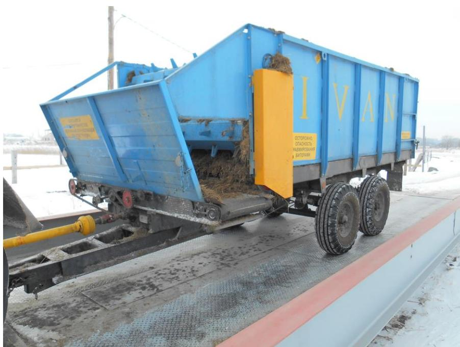
Кормораздатчик тракторный полуприцепной
