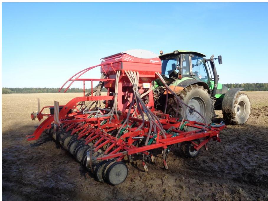
Сеялка пневматическая KVERNELAND ts-drill
