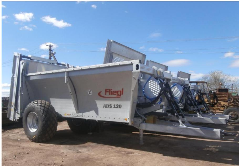
**Полуприцеп с выдвижной системой ADS 120**
