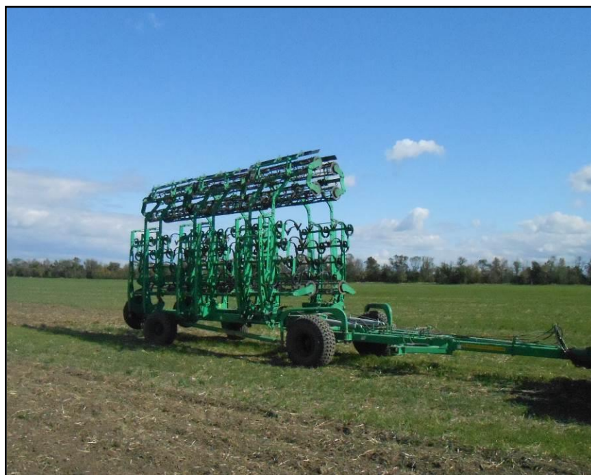
Культиватор блочно-модульный прицепной КБП12-4 К1
