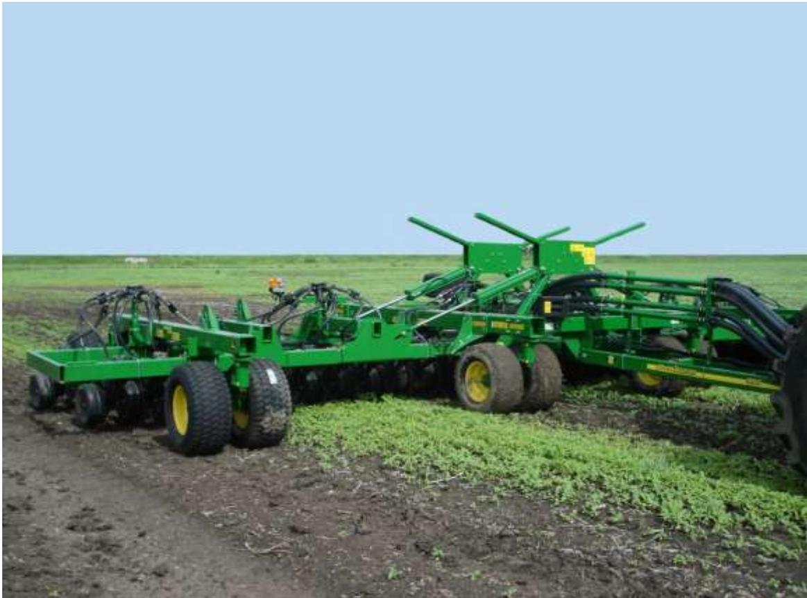
**Сеялка пневматическая прицепная модели 1890**
