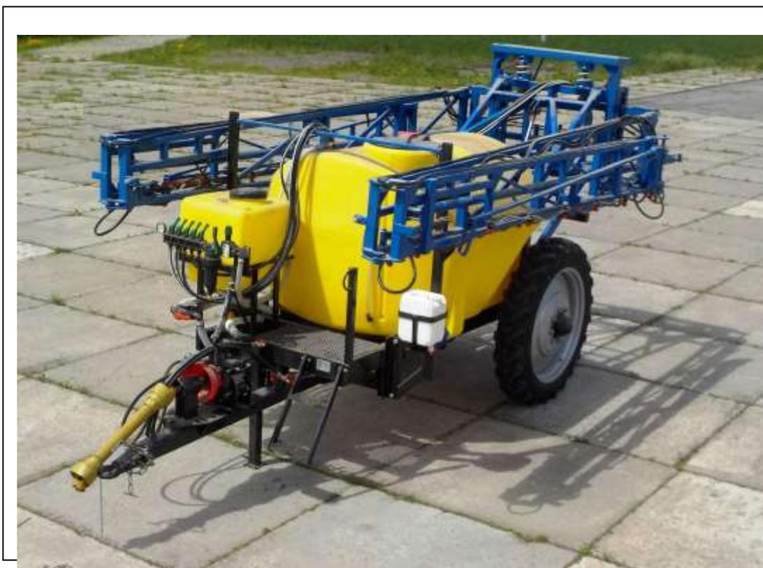
**Опрыскиватель полуприцепной штанговый ОП-22-2500**
