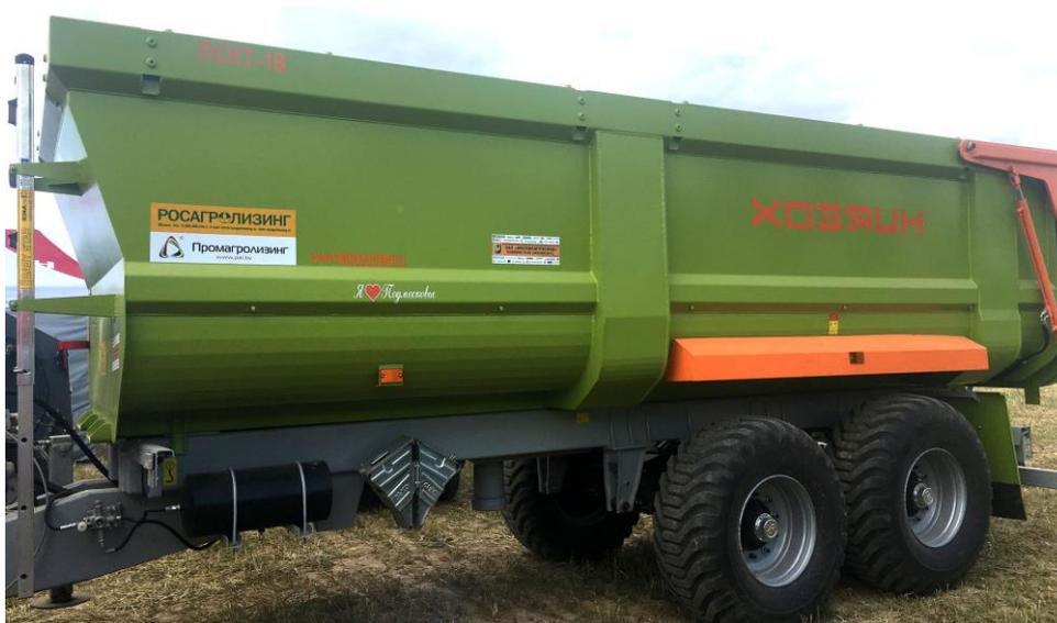
**Полуприцеп самосвальный ковшовый тракторный
