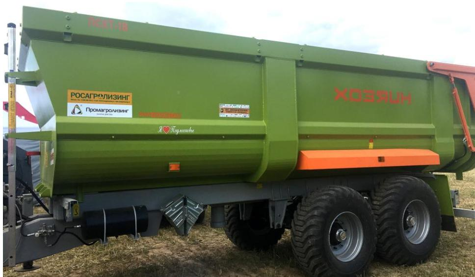
**Полуприцеп самосвальный ковшовый тракторный
