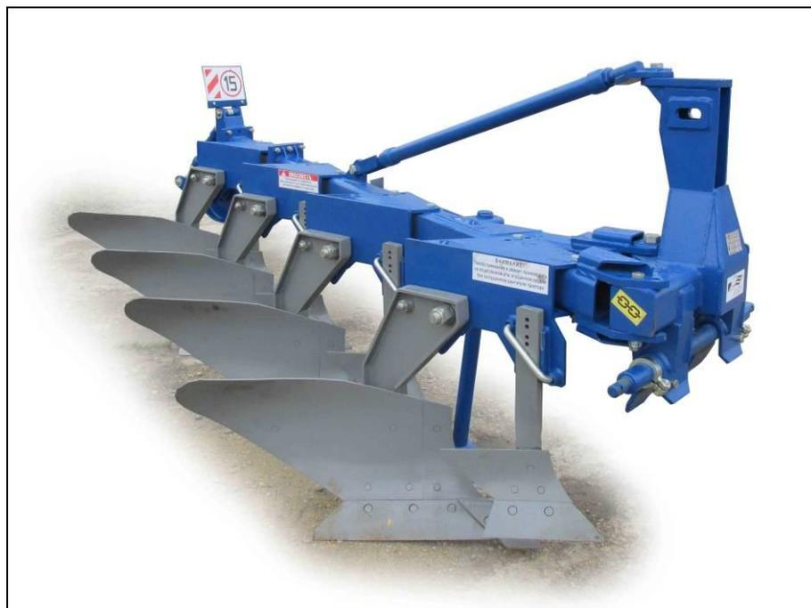
**Плуг навесной с регулируемой шириной захвата и изменяемым
