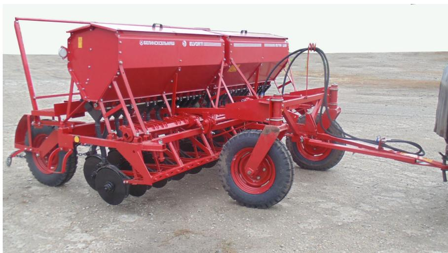
**сеялки зернотуковой прессовой СЗП-3,6Б**
