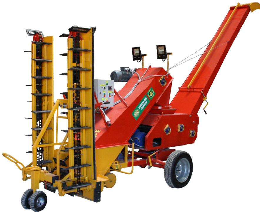
**погрузчика-зернометателя скребкового ПЗС-160**
