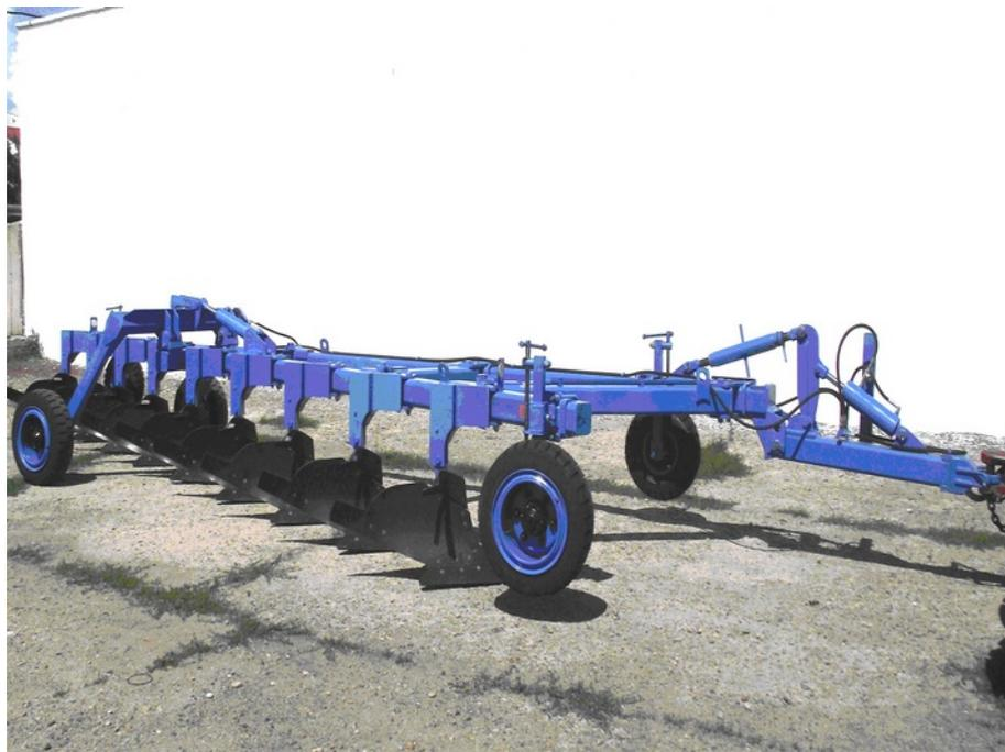
Плуг полуприцепной с регулируемой шириной захвата ПЛПР-9×40
