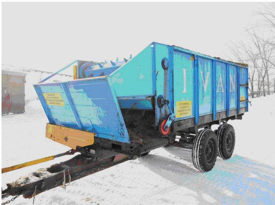
Кормораздатчик тракторный полуприцепной
